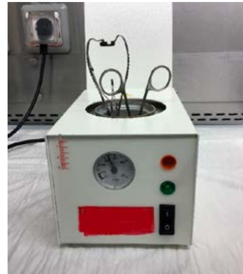
Figuur 3. Voorbeeld van een Hot-Bead sterilisator. Glaspareltjes van maximaal 1 mm doorsnede worden tot 250 ° C verwarmd en doden in 15-20 seconden alle micro-organismen en sporen.
